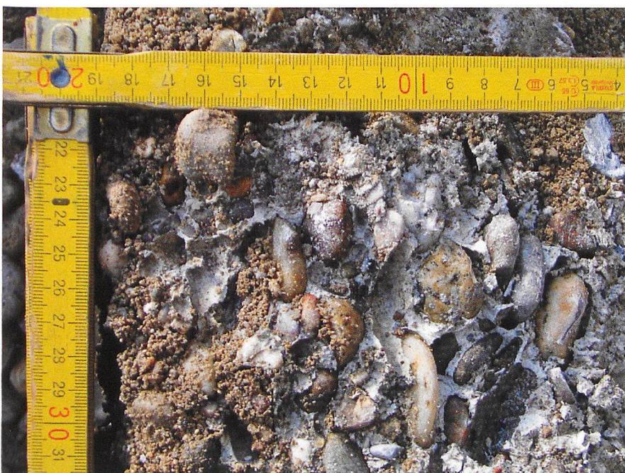
Fig. 9: Nahaufnahme der Injektion.
