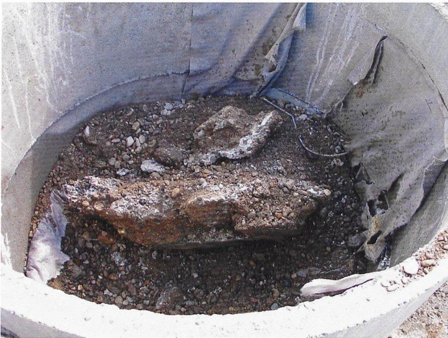
Fig. 8: Injektionsbereich in Leithaschotter.
