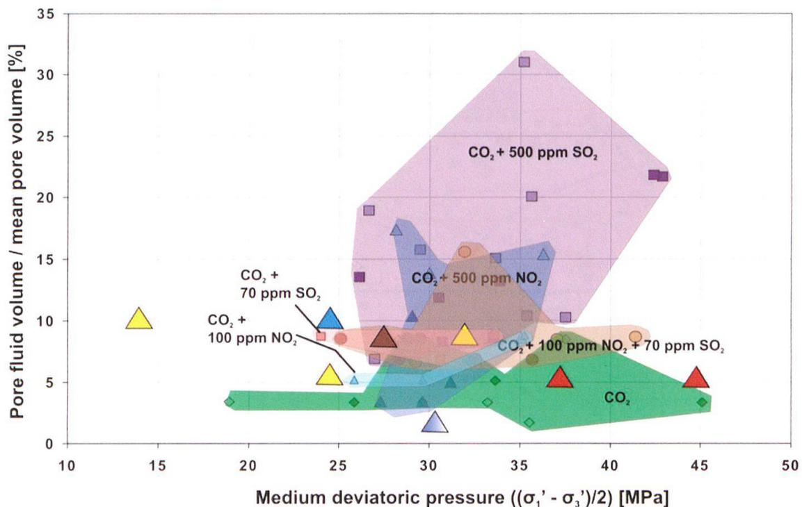
Fig. 5: Anteil des von verschiedenen CO<sub>2</sub>-Fluiden genutzten Porenraums während der deviatorischen Belastung im Triaxialtest.
