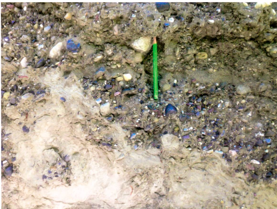
Fig. 6: Der Dyke im Frühling 2016: Nahaufnahme seines distalen Endes. Gut erkennbar sind die Sand/Kies-Komponenten, welche im Silt/Sand des Dykes schwimmen und vermutlich aus dem Umgebungslockergestein stammen dürften.
