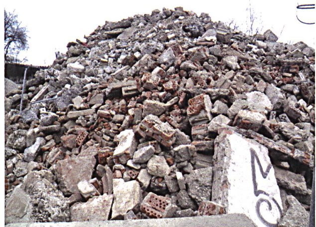
Fig. 2: Mischabbruch aus Gebäuderückbau (Foto: D. Hiltbrunner).
