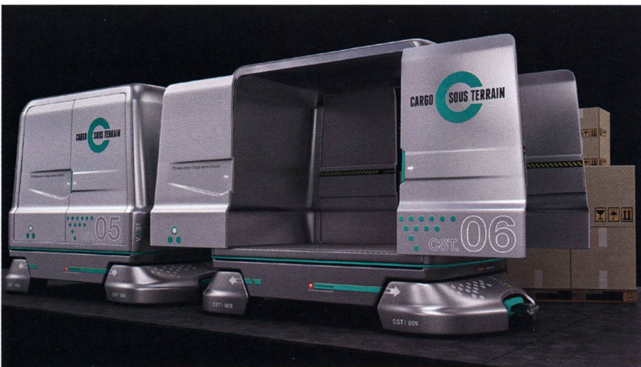
Fig. 4: Visualisierung der CST-Transportfahrzeuge mit Ladungsmodulen für 2 Europaletten.
