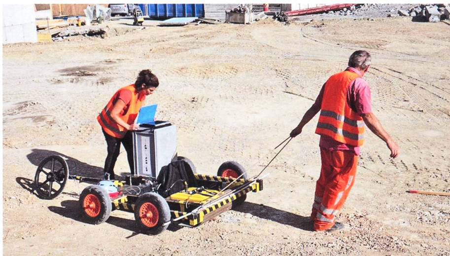
Fig. 8: Das Georadar-Equipment in Aktion (Bild Th. Rügegg, 15.08.2017).
