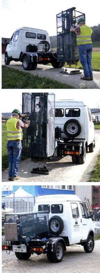
Fig. 3: Fallgewichts-hybridseismische Kartierung der Untergrundstrukturen im Rahmen eines Geothermieprojekts im Auftrag der Services Industriels de Genève (SIG). Die Messstrecke liegt zu 80% in urbanem Gebiet mit dichter Besiedlung.
