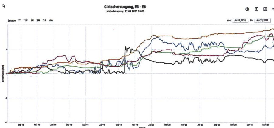
Fig. 12: Ausschnitt der Aufzeichnung der Messresultate der Extensometer.
