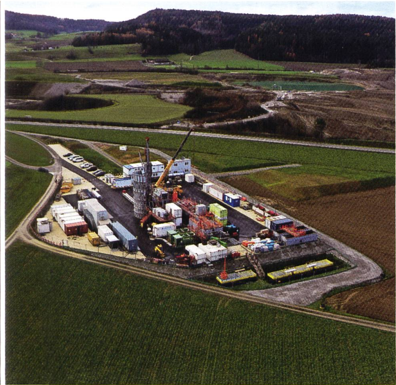
Fig. 2: Links: Skizze der geplanten Bohrplatzauslegung der Tiefbohrung Stadel-3; rechts: Vollständig eingerichteter Bohrplatz. Die Tiefbohrung Stadel-3 befindet sich im Standortgebiet Nördlich Lägern und wurde mit einem Langzeitbeobachtungssystem ausgestattet. Foto: Nagra.
