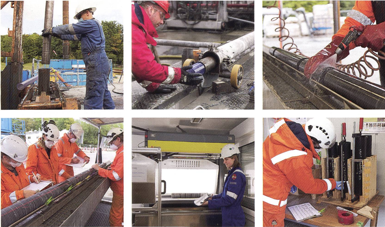
Fig. 4: Vor-Ort Arbeitsabläufe für Bohrkern im Rahmen der Tiefbohrkampagne. Jeweils von links nach rechts; oben: Entnahme Innenkernrohr – Entnahme Bohrkern mit schützendem Plastikrohr – Reinigung; unten: Erste Bohrkern-Dokumentation – Bohrkern-Scan (vgl. Fig. 5) – Beprobung. Fotos: © Comet Photoshopping GmbH, Dieter Enz.
