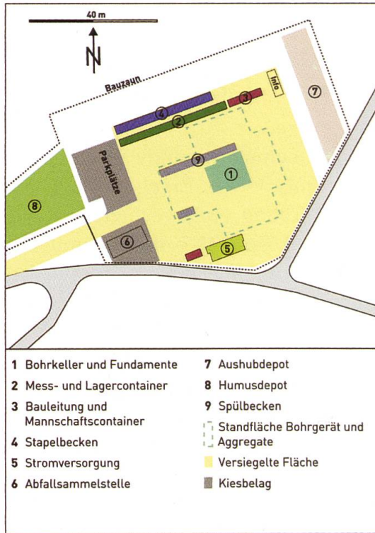
Fig. 2: Links: Skizze der geplanten Bohrplatzauslegung der Tiefbohrung Stadel-3; rechts: Vollständig eingerichteter Bohrplatz. Die Tiefbohrung Stadel-3 befindet sich im Standortgebiet Nördlich Lägern und wurde mit einem Langzeitbeobachtungssystem ausgestattet. Foto: Nagra.
