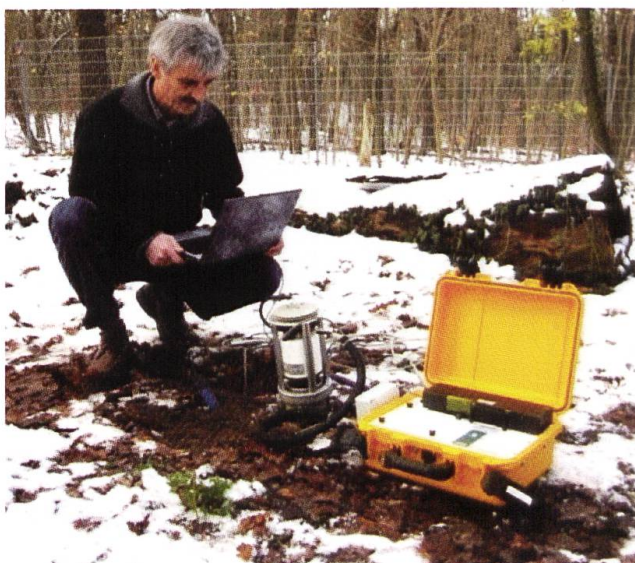
Fig. 5: Station zur Messung des \text{CO}_2 -Bodenflusses und der Bodentemperatur auf dem Betriebsgelände in Ketzin (links, Zimmer et al. 2011). Daten aus der Phase der \text{CO}_2 -Injektion 2008-2013 zeigen den gleichen typischen Jahresverlauf wie Daten aus der Pre-Injektionszeit 2005-2007 (rechts).
