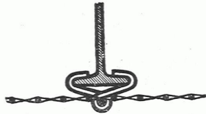
Abb. 6. Befestigung von Rauchs Reformrabitzen an eisernen T-Balken.
