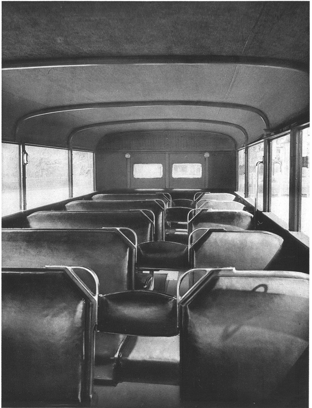
INNERES EINES GESCHLOSSENEN AUTOBUS / SAURER A.G., MASCHINENFABRIK UND GIESSEREI, ARBON Sachliche, einfache Ausstattung / Jede Form entspricht aufs knappste der Aufgabe; Eleganz entsteht durch die klare Wirkung der ohne Zierat verarbeiteten Materialien: Leder, Holz, Metall; konform den Begriffen der Präzision, Geschwindigkeit, unaufdringlicher Einklang mit der Funktion
