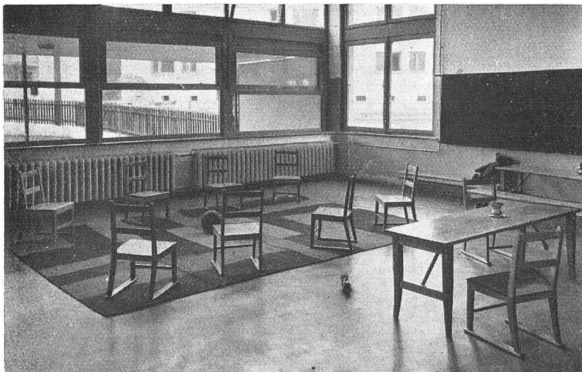
KLEINKINDERSCHULE DER WOHNKOLONIE EGLISEE • BODENBELAG LINOLEUM GIUBIASCO, UNI NILGRÜN
