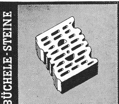
BEI VERWENDUNG VON B. K. S. TONKAMMERSTEINEN. Der Stein kann in jeder Lage leicht mit einer Hand gefasst und versetzt werden. Der Mauerungsvorgang ist denkbar einfach und geht rasch vor sich, da eine Steinbreite auch zugleich die ganze Mauerbreite darstellt. Die schmalen Kammern verhindern das Eindringen des Mörtels, werden von diesem nur überbrückt, sodass eine geschlossene Deckfläche entsteht.
