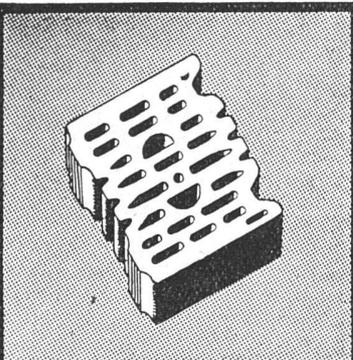
BEI VERWENDUNG VON B. K. S. TONKAMMERSTEINEN. Der Stein kann in jeder Lage leicht mit einer Hand gefasst und versetzt werden. Der Mauerungsvorgang ist denkbar einfach und geht rasch vor sich, da eine Steinbreite auch zugleich die ganze Mauerbreite darstellt. Die schmalen Kammern verhindern das Eindringen des Mörtels, werden von diesem nur überbrückt, sodass eine geschlossene Deckfläche entsteht.
