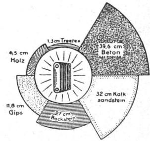
bietet den gleichen Kälte- und Wärmeschutz wie eine 27 cm Backsteinmauer;
