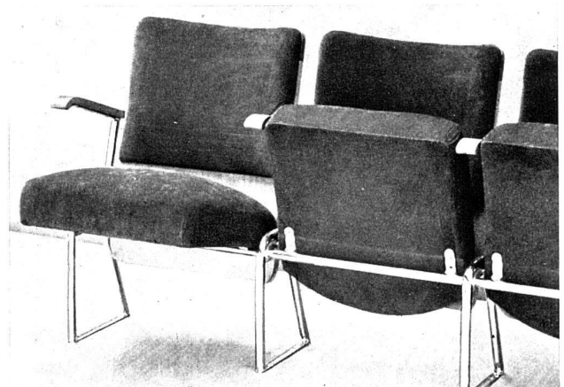
Doggen aus verchromtem Stahlrohr. Rücken aus Sperrholzplatte über massiv gebogenem Holzrahmen, zu je 4 aneinandergeleimt. Bezug in hochrotem Manchester-Cord.
