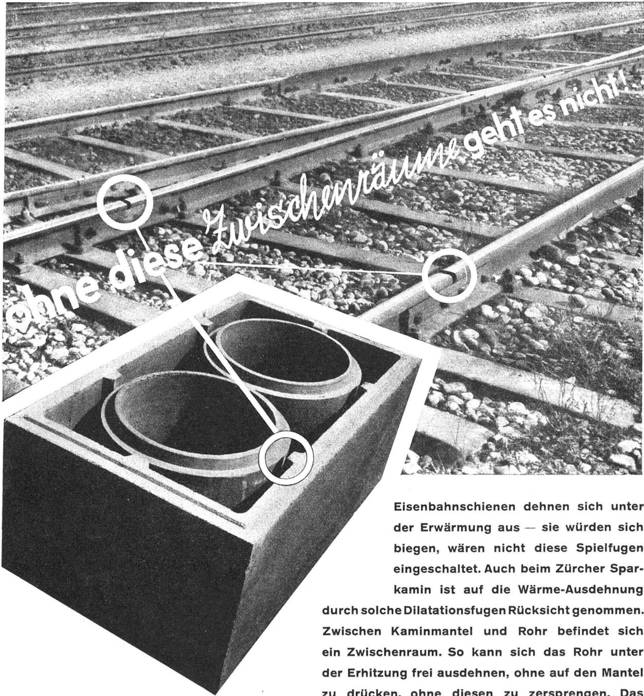
Eisenbahnschienen dehnen sich unter der Erwärmung aus — sie würden sich biegen, wären nicht diese Spielfugen eingeschaltet. Auch beim Zürcher Sparkamin ist auf die Wärme-Ausdehnung durch solche Dilatationsfugen Rücksicht genommen. Zwischen Kaminmantel und Rohr befindet sich ein Zwischenraum. So kann sich das Rohr unter der Erhitzung frei ausdehnen, ohne auf den Mantel zu drücken, ohne diesen zu zersprengen. Das
