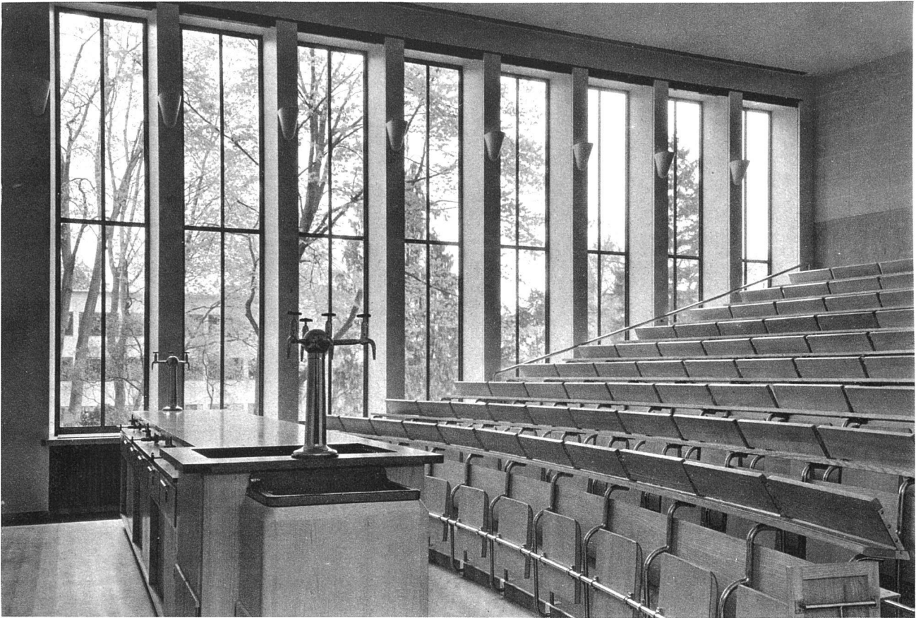
Auditorium, mit Gestühl in Eschenholz und Antikorodaltragwerk. Druckknopfsteuerung für Verdunkelung und Tafeln. Demonstrationstisch mit reicher technischer Ausstattung. Beleuchtung durch Deckenstrahlung an den Fensterpfeilern
