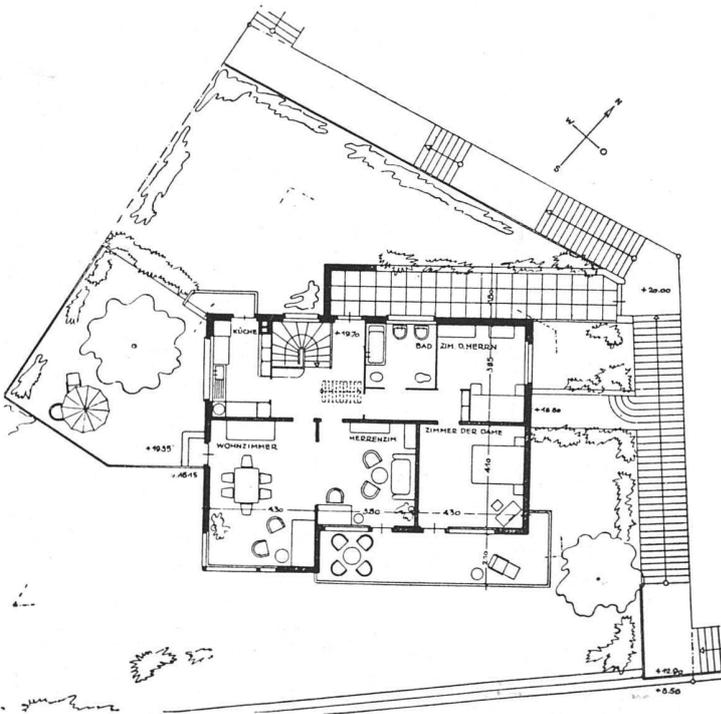
Konstruktion: Sockel und Untergeschoss armerter Beton, Haupt- und Obergeschoss nur bergseits massiv, hangseitiger Teil Holzriegelbau, beidseits verschalt.
