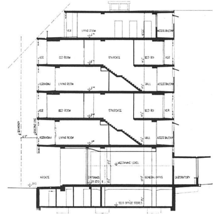
Querschnitt durch die zweigeschossigen Apartments
