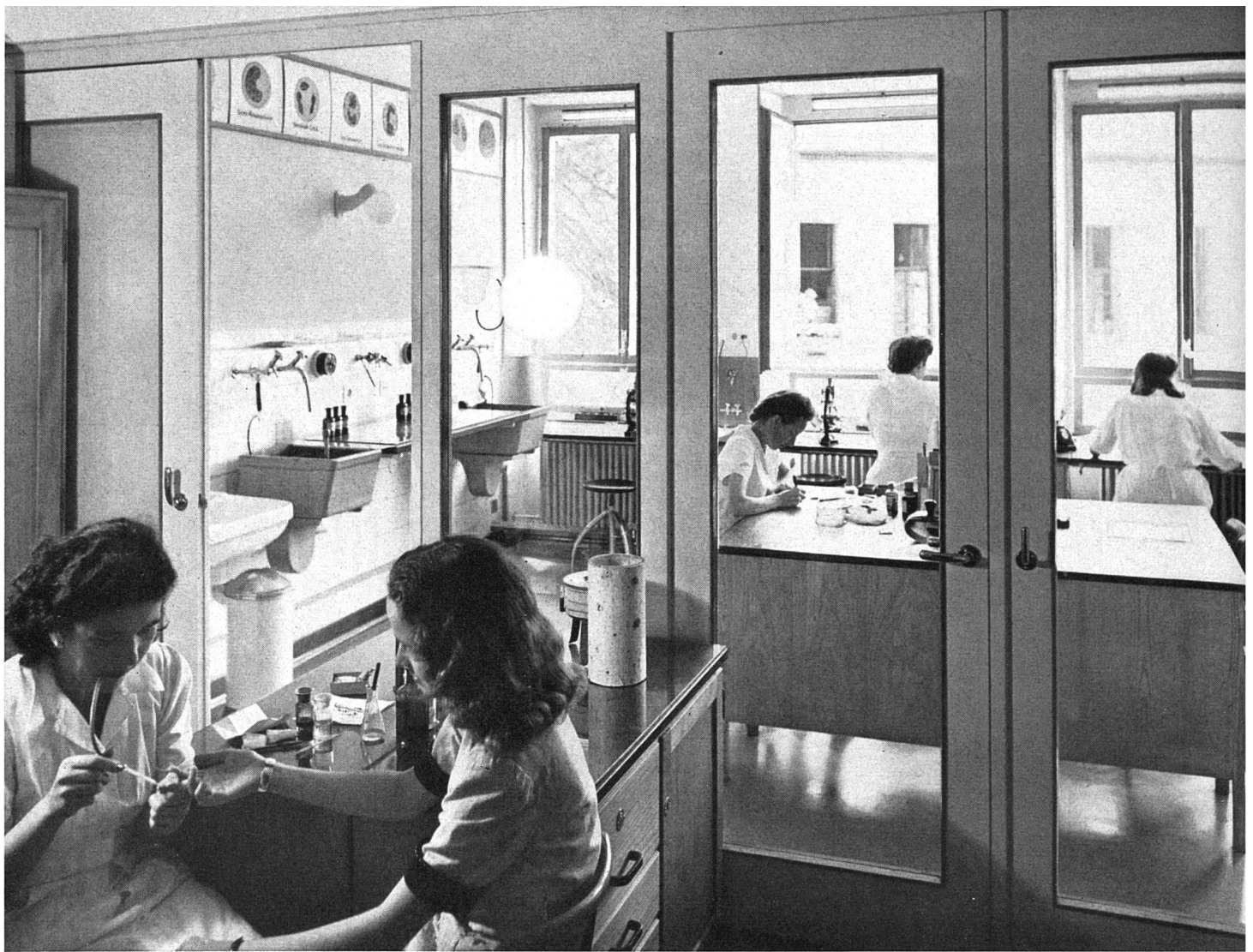
Abb. 72 Haematologisches Labor mit Vorraum für Patienten. Links säurefester Wandausguß AKZ (Fabrikat Steinzeugfabrik Embrach AG, Separation für Wasserstrahlpumpen)
