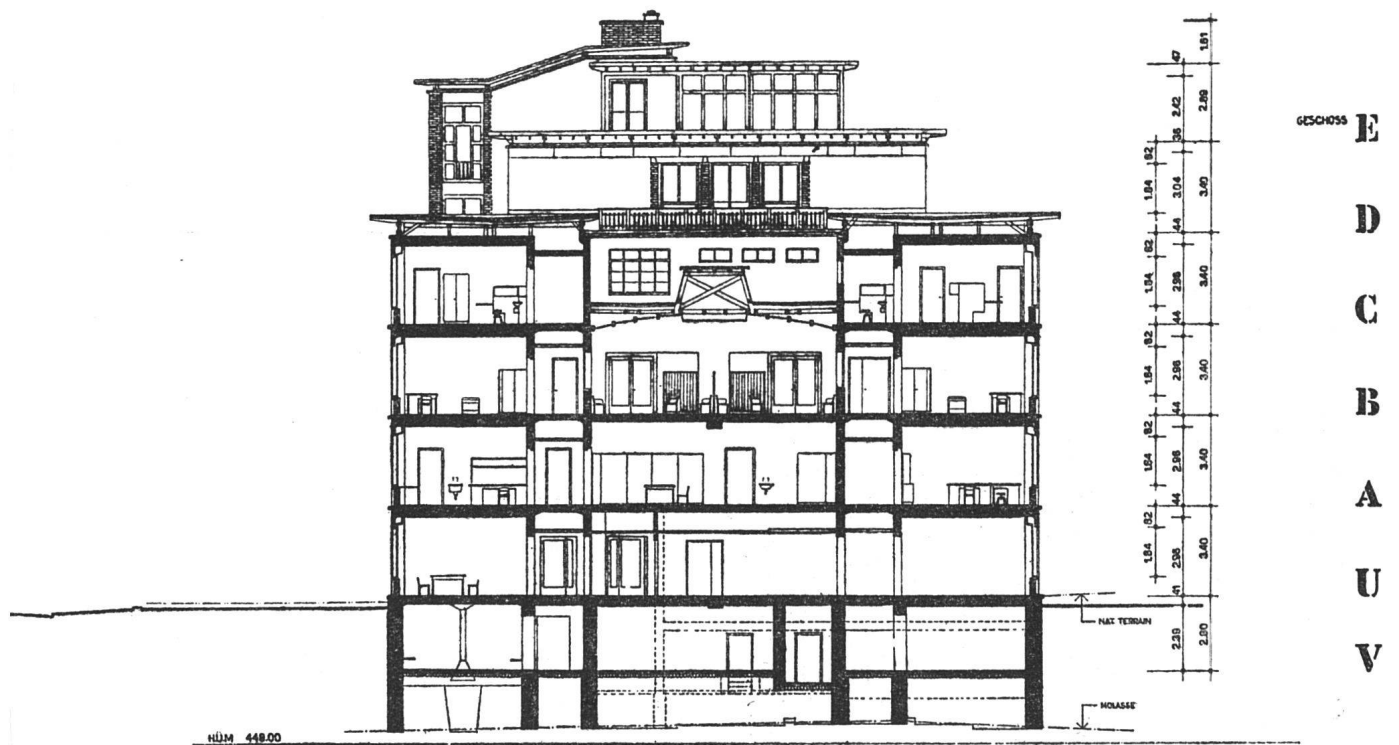
Querschnitt durch Südbau, Blick nordwärts 1 : 300
