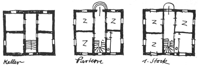
Der paralytisierte Grundriß mit tragenden Innen- und Außenmauern / Le plan rigide avec murs extérieurs et intérieurs portants / The rigid plan with supporting interior and exterior walls
