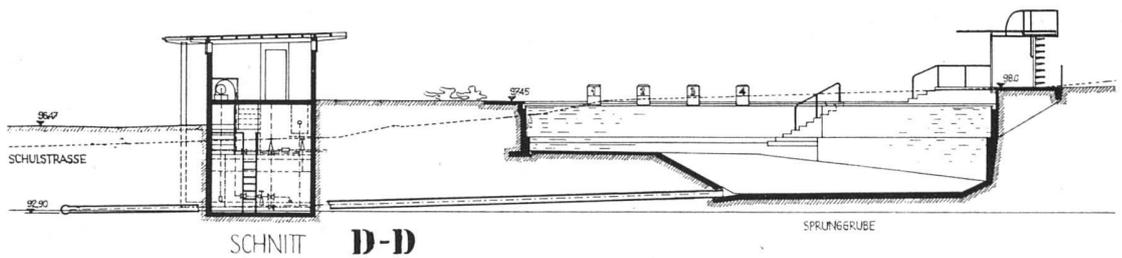
Querschnitt durch Filtergebäude und Nichtschwimmerbecken 1:300 | Coupe transversale du bâtiment de filtre et le bassin pour non-nageurs | Section through filtering plant and pool for non-swimmers
