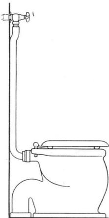
Der kurzgebaute **KWC**-Spülhahn soll bisherige Modelle mit unpraktisch großer Auskrägung ersetzen. Er wird, zur Verminderung des Wohnlärms, auch in PAX-Ausführung geliefert.
