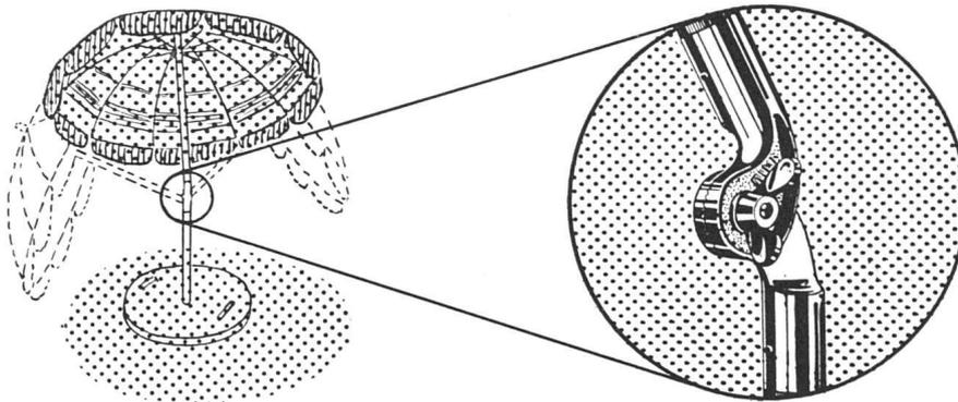
Dank seinem praktischen und soliden Verstell-Gelenk läßt er sich mühelos nach allen Seiten drehen und in jede Schräglage bringen. Das bedeutet ein leichtes Anpassen des Schirmes an jeden Sonnenstand, ohne dabei den Standort verschieben zu müssen.
