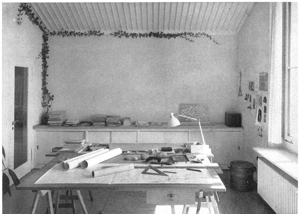
Arbeitszimmer des Architekten. Holzdecke im Dachprofil, Wände Naturputz, Boden Linol Studio de l'architecte. Plafond en bois, suivant la pente du toit; parois recouvertes d'enduit naturel; sol de linoléum | The architect's study. Wooden ceiling, following the pitch of the roof; walls finished in unpainted plaster, floors in linoleum
