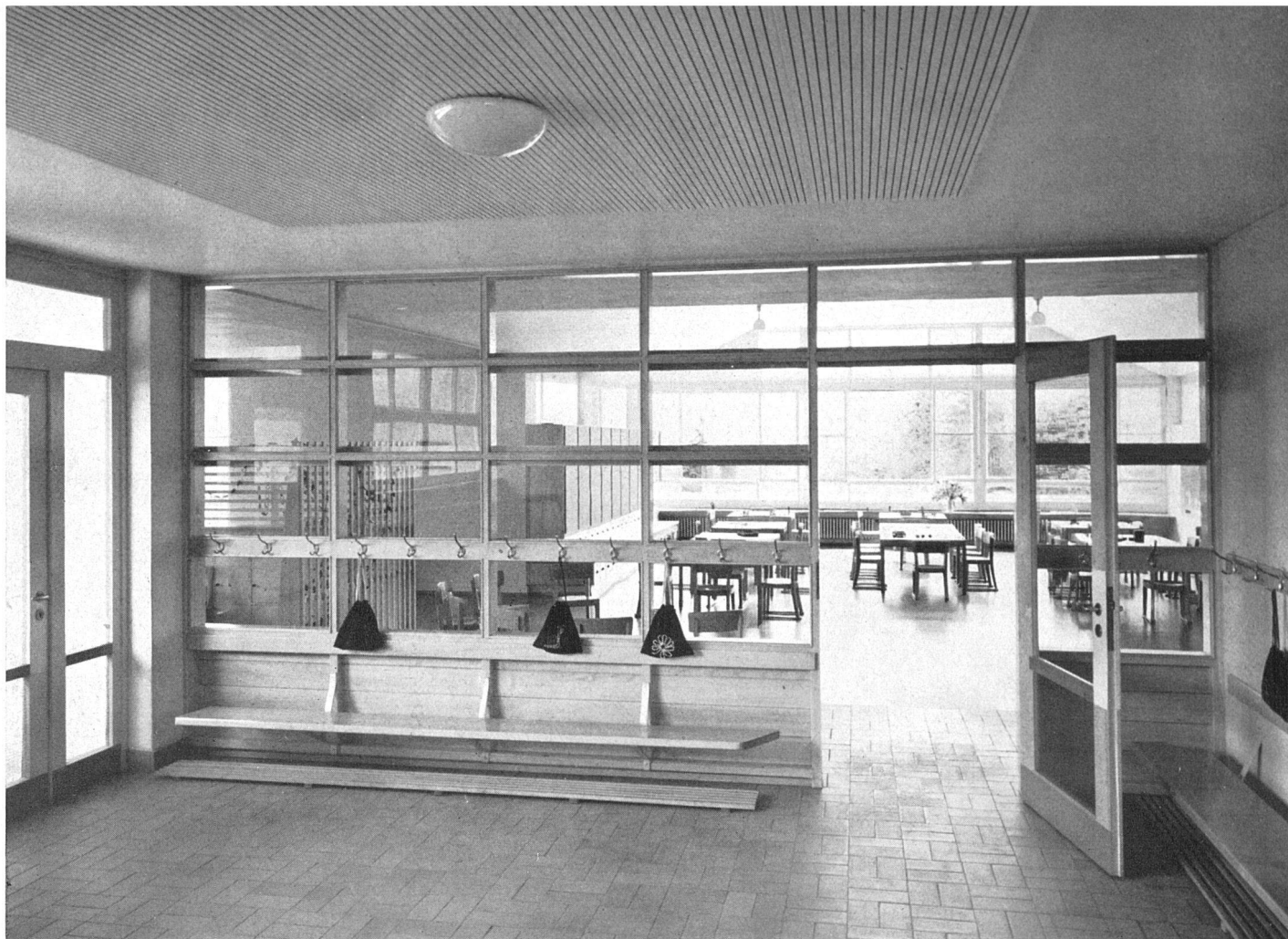
Garderobehalle mit Durchblick ins Hauptlokal. Boden aus Ziegelplatten, Akustikpavatex an der Decke, Wände hellblau | Vestiaire et vue vers la principale. Plancher en dalles céramiques, plafond en «Pavatex» antisonore, parois vernies bleu clair | Cloakroom and view towards the main room. Tiled floor, acoustic fibreboard ceiling, light blue walls
