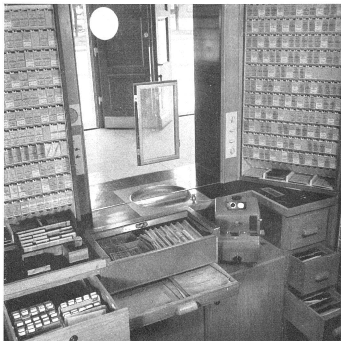
3 Schalteranlage mit Drehteller, Versenkkasse, Tico-Kontrollapparat, Handtarif und Hygiaphon-Sprechflügel / Vue d'ensemble d'un guichet avec assiette tournante, caisse à descente en biais, appareil de contrôle Tico, tarifs, membrane acoustique Hygiaphone / Ticket window with rotating plate for the change, built-in cash box, ticket control instrument, fare tables and Hygiaphon speaking membrane
