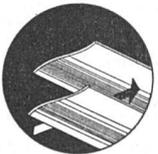
Diese Schrägstellung der S-förmigen Lamellen bricht die Sonnenstrahlen und ergibt gleichmäßige, indirekte Beleuchtung
