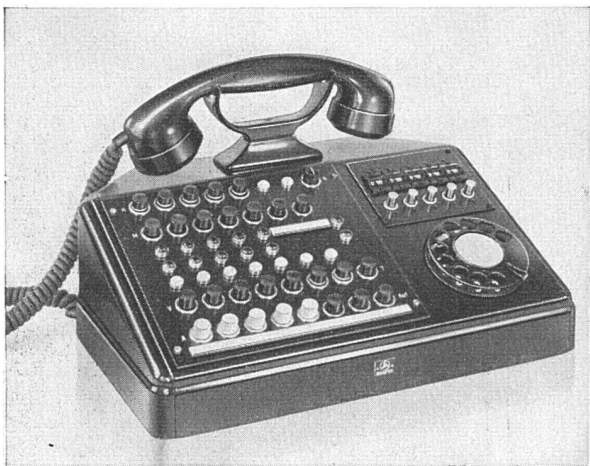
Vermittlungsstation für Telephonanlagen mit 5 Amtsleitungen.
