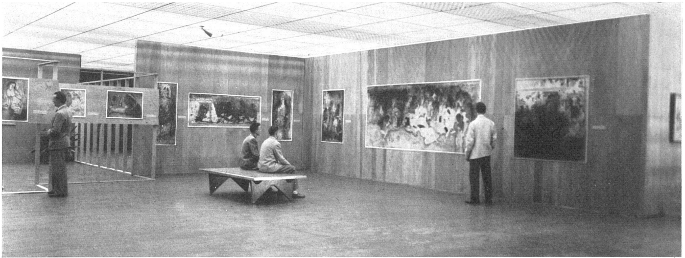
Neutraler Ausstellungsraum, frei aufgeteilt durch Stellwände. Gleichmäßige künstliche Beleuchtung durch Leuchtröhren über Raster; zusätzliche Punktalscheinwerfer im Raum. Schleier Memorial Gallery, Denver, Colo. | Salle d'exposition neutre, librement articulée par des panneaux mobiles. Des tubes lumineux disposés au-dessus du plafond donnent un éclairage artificiel également réparti | Neutral exhibition room, divided up freely by mobile panels. Even artificial illumination from line fluorescents above the grid.
