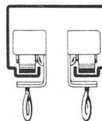
Für Großbühnen führen wir ein extra starkes Profil mit Hartgummirollen, welche mit Kugellager ausgerüstet sind.
