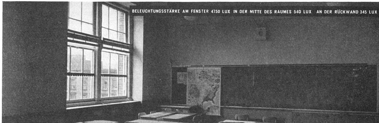
BELEUCHTUNGSSTÄRKE AM FENSTER 4750 LUX IN DER MITTE DES RAUMES 540 LUX AN DER RÜCKWAND 345 LUX
