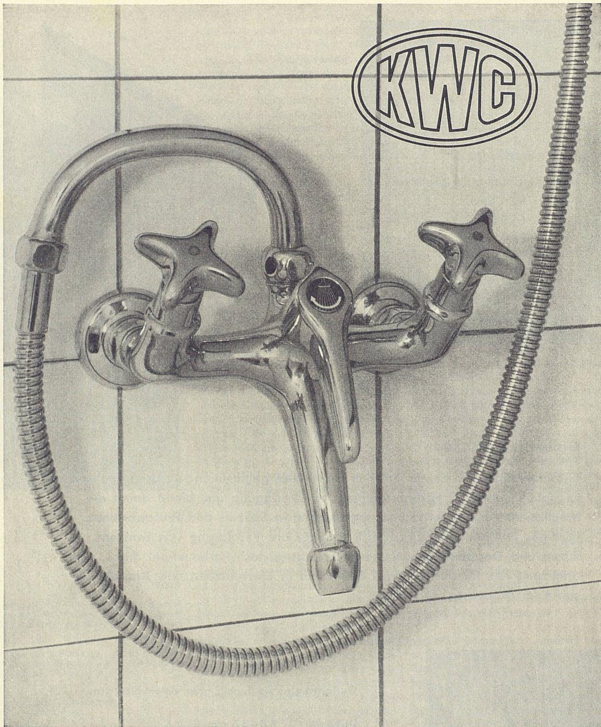
Die oben abgebildete Badebatterie Nr. 1720 Neo zeichnet sich aus durch die handlich geformten, in praktischer Schräglage nach oben stehenden Griffe. Glatte gerundete Formen und die Vermeidung von Schmutzwinkeln gewährleisten leichtes Reinhalten. Zum Vergleich diene nebenstehende Abbildung alter Ausführung.
