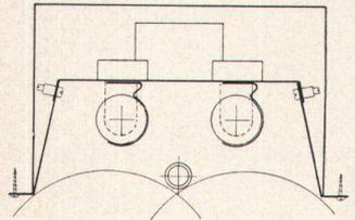
Deckeneinbauleuchte für Turnhallen zur Aufnahme von 2 verspiegelten Fluoreszenzlampen mit Schutzstange und Röhrensicherungshalter.
