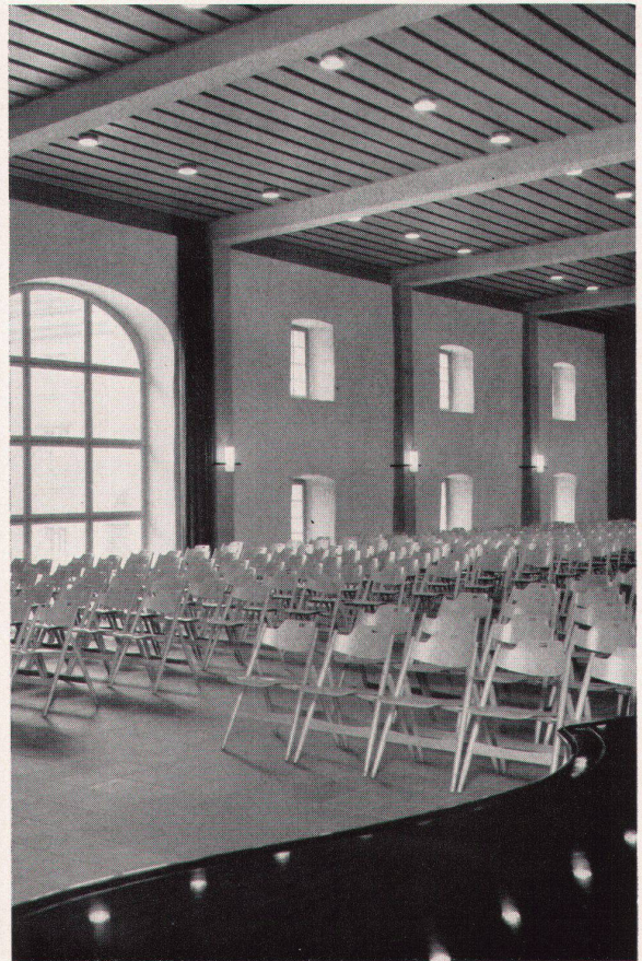
8 Großer Saal mit 600 Sitzplätzen, Blick von der Bühne zur Nordwand. Binder in Sichtbeton, vor die alten Mauern gestellt, Decke in Tannenholz La grande salle de 600 places assises: la salle vue de la scène vers le nord. Fermes en béton apparent posées devant les vieux murs, plafond en sapin Main hall with 600 seats; view from the stage across the hall to northern end. Girders made of exposed concrete were erected in front of the original old walls. Pinewood ceiling
