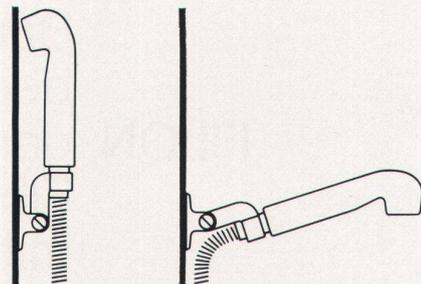
Grösste Verstellbarkeit der Strahlrichtung ohne Knickgefahr für den Schlauch
