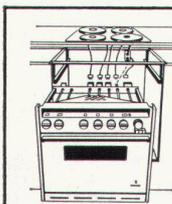
Mit wenigen Handgriffen sind die Kochplatten mit den Steckverbindungen angeschlossen und der Herd auf
