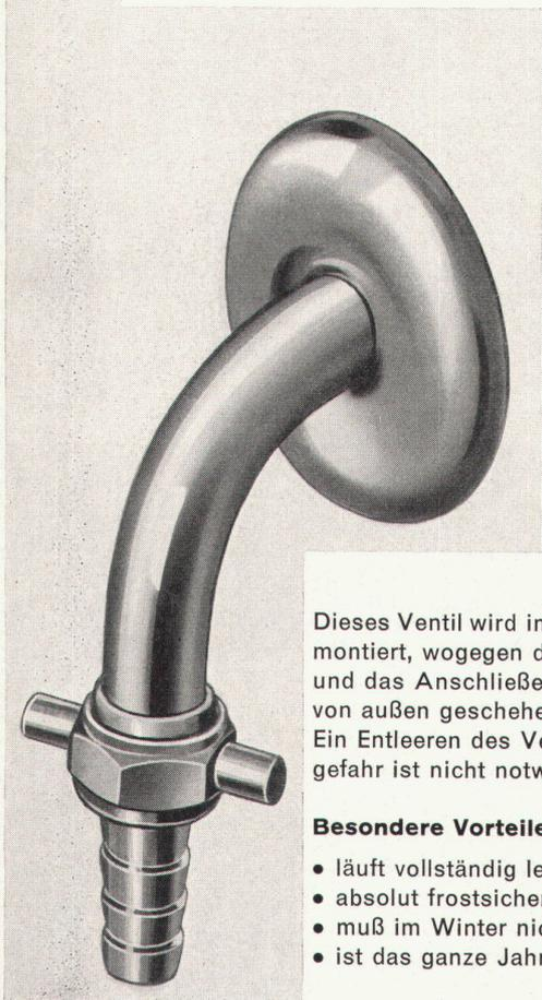
Dieses Ventil wird im Innern des Hauses montiert, wogegen dessen Betätigung und das Anschließen des Schlauches von außen geschehen. Ein Entleeren des Ventiles wegen Frostgefahr ist nicht notwendig.
