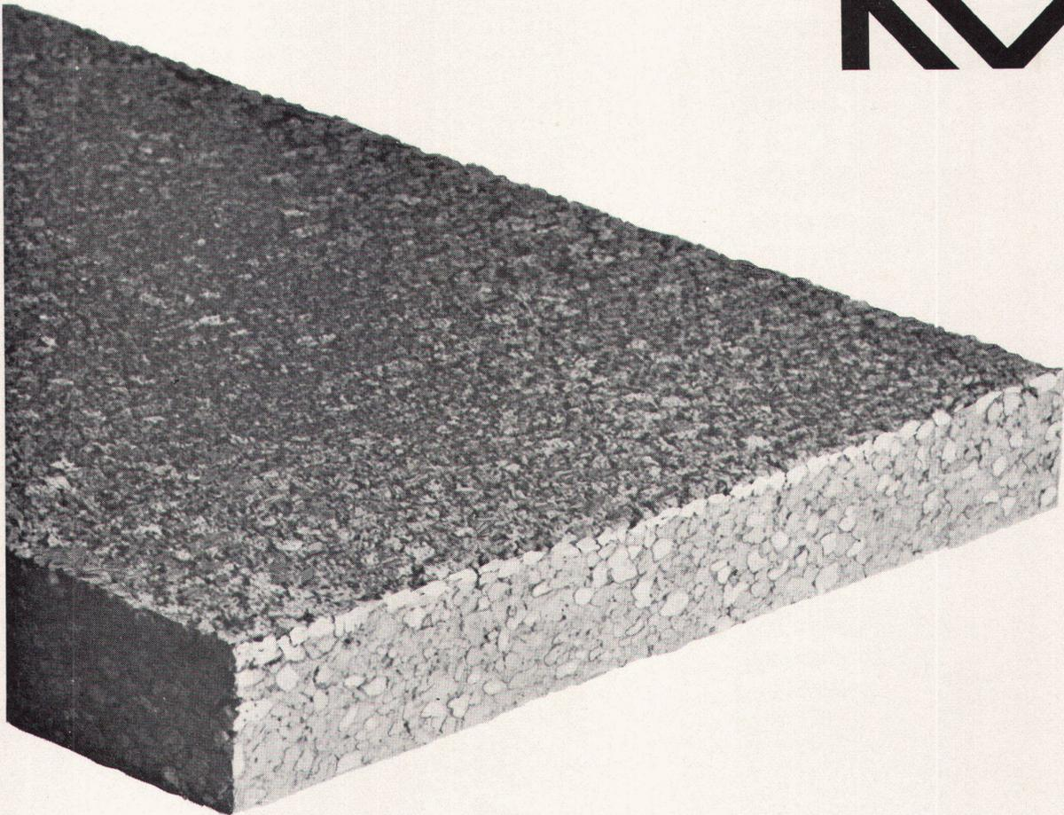
Kork ist ein hochwertiges Isoliermaterial gegen Kälte und Wärme. Seine Wärmeleitfähigkeit beträgt nur 0,028 Kcal/m, h, °C (Bestwert bei Zimmertemperatur\*). Kork altert nicht, schwindet nicht und wird geschätzt wegen seines Verhaltens gegenüber Feuchtigkeit; seine luftgefüllten Zellen sind wasserabstossend und können atmen. Jedes hochwertige Isoliermaterial muss elastisch sein; Kork ist sogar dauerelastisch.
