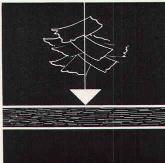
Spezielle, kreuz und quer verleimte Feinspäne ergeben eine millimeterdicke, richtungslose, tadellos plane und dichte Absperrung. Deshalb die schöne und ruhige Oberfläche jeder NOVOPAN-Platte!
