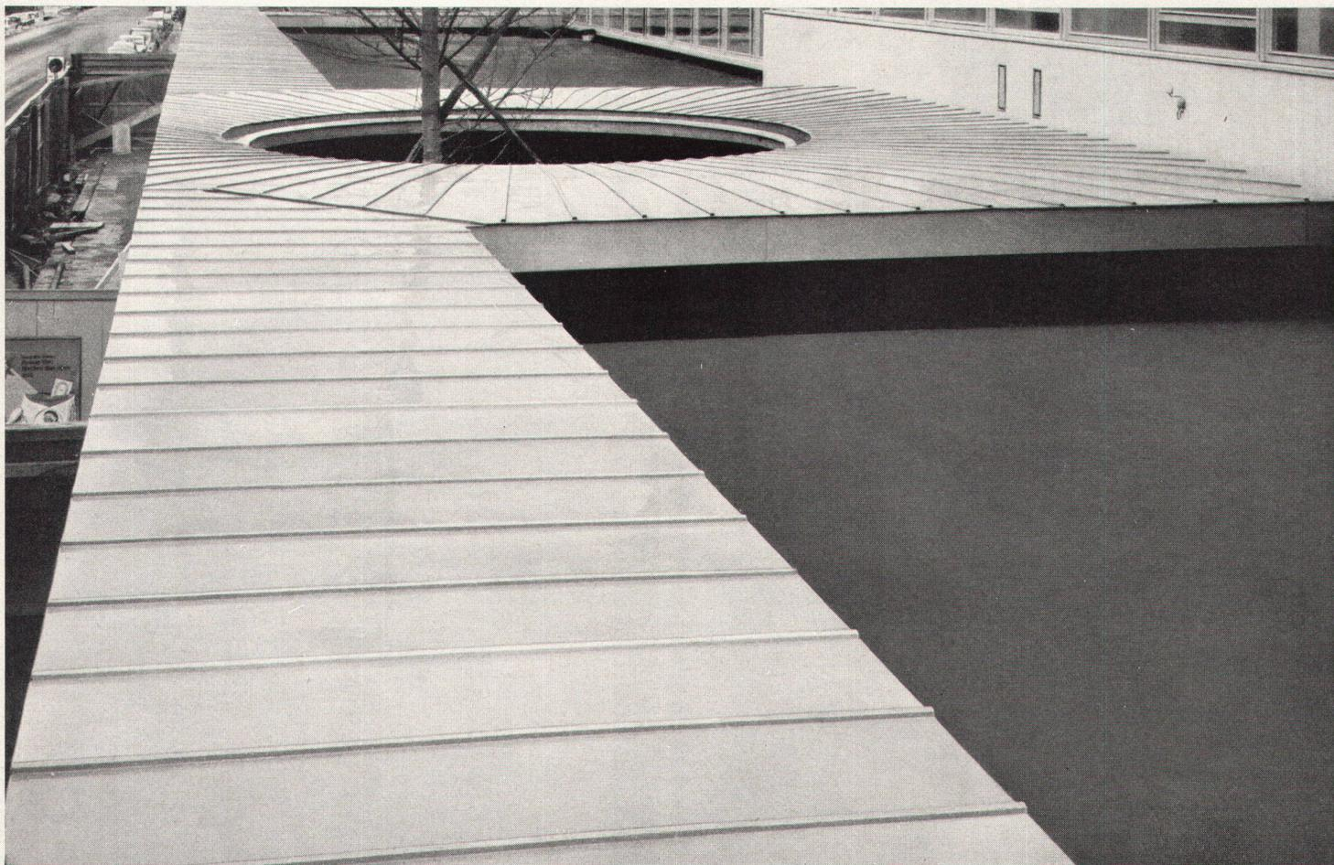
ALURIP kann mit metallisch blanker oder stahlgrauer Patina-Oberfläche, oder aber chemisch oxydiert geliefert werden. ALURIP wiegt nur 2,2 kg/m<sup>2</sup> und läßt sich normalerweise für Bedachungen bis zu 4% Neigung verwenden. ALURIP eignet sich auch für konische und gewölbte Dachformen. Einfache, schnelle Montage, unsichtbare Befestigung.
