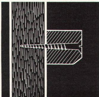
Die harte Deckschicht zusammen mit den groben Mittellagespreißen ergeben die große Festigkeit. Deshalb die vorzügliche Schraub- und Nagelfestigkeit jeder NOVOPAN-Platte!
