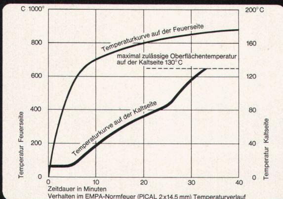
Die Isolierplatte PICAL können Sie nicht anzünden. Sie ist unbrennbar und wird deshalb am Bau als feuerhemmende Verkleidung eingesetzt. **PICAL-Isolierplatten bilden eine ideale Brandbarriere. Sie sind feuerhemmend und werden gemäss Attest der EMPA im Brandfalle weder qualmen, noch tropfen oder giftige Gase abgeben.**
