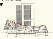
Längsschnitt, Hängedach und Schrägfassade
