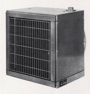
Für das schnelle und wirksame Trocknen von Wäsche ist es wichtig, dass eine rege Umwälzung von Warmluft im Trockenraum geschaffen wird. Der Warmluftapparat besteht aus einem Axialventilator mit 2 Geschwindigkeiten und einem Wärmeaustauscher für Warmwasser, welche in einem Stahlblechgehäuse eingebaut sind, sowie einem Satz Montageeisen zum Befestigen des Wäschetrockners an der Wand. Gehäuse und Montageeisen sind mit grauem Hammerschlaglack gestrichen.
