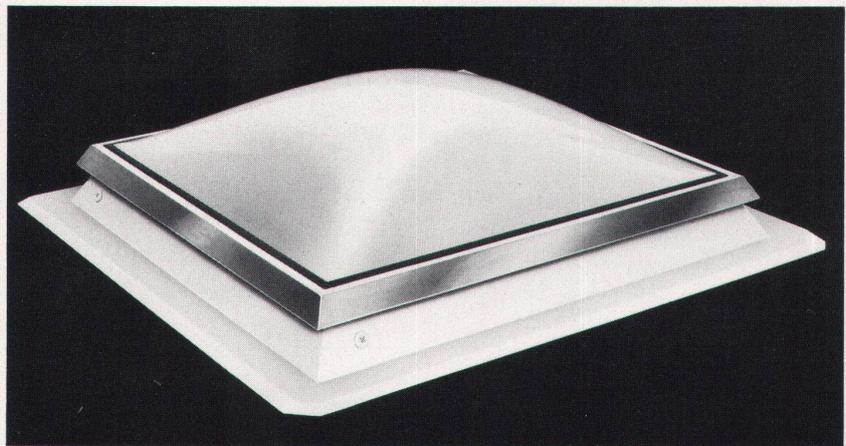
Tragendes Element jeder CUPOLUX-Lichtkuppel ist ein massiver Aufsetzkranz aus Polyurethan-Duromerschaum. Dieses homogene, mit einer doppelten DD-Lackierung überzogene Material von bester statischer Festigkeit ist extrem wasser- und witterungsfest. Der 15 cm breite Klebeflansch des Aufsetzkranzes gewährleistet die problemlose Verbindung mit allen handelsüblichen Flachdachabdichtungen.
