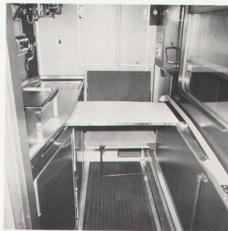
T2S, Office: links Halterahmen für Kochplatte; Klappsitz und Drehtisch als Arbeitsplatz eingerichtet, Bett für Dienstbegleiter aufgeklappt (Fotos zu T2S: Schlieren)
